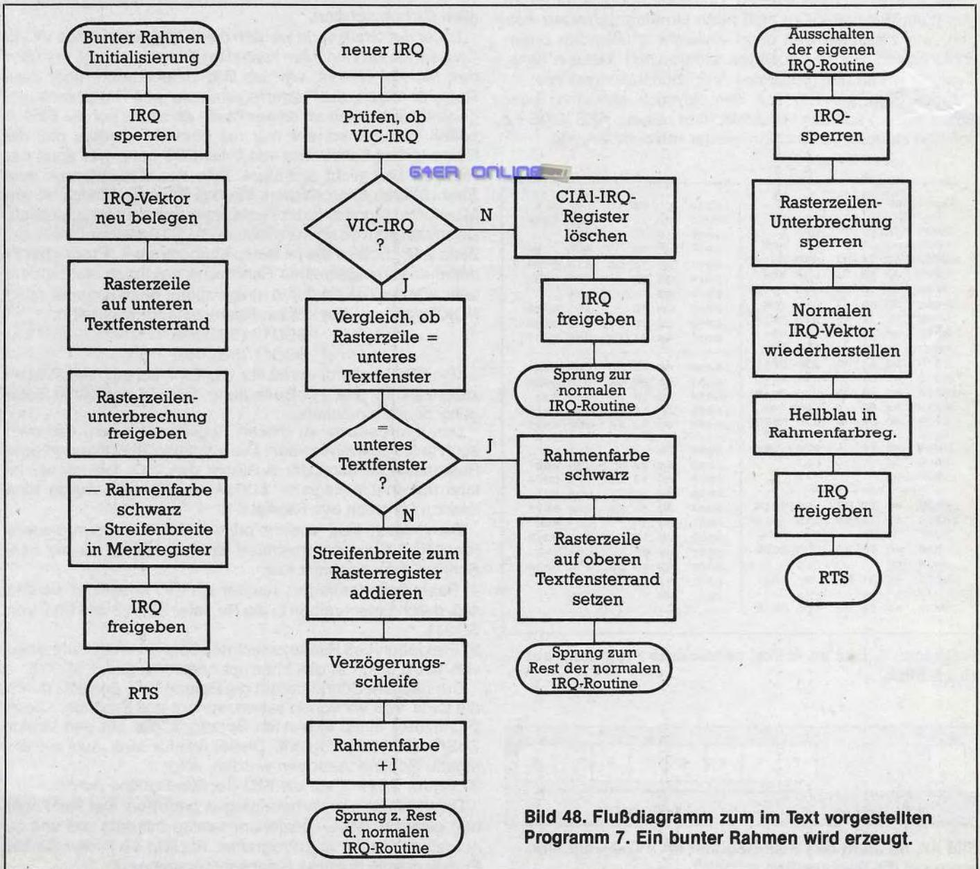
Bild 48. Flußdiagramm zum im Text vorgestellten Programm 7. Ein bunter Rahmen wird erzeugt.
